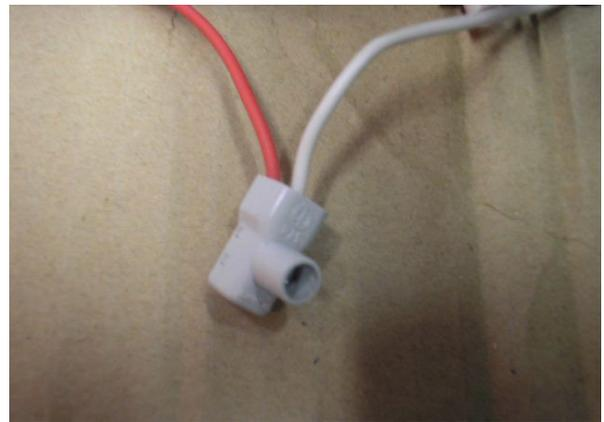
**Figura 7.8** Collegamento dei moduli in parallelo
